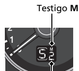
Testigo de la palanca de cambios
